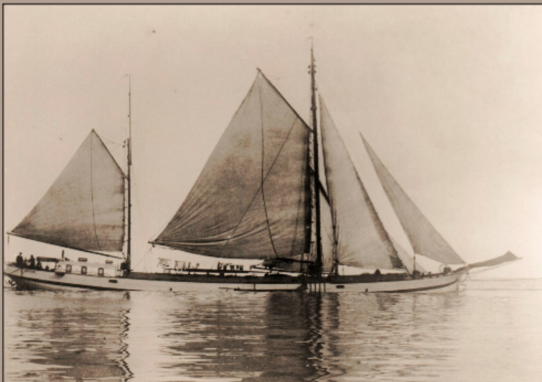
[ca 1910] De Progres, stalen tweemast zeilklipper, onder zeil. Gebouwd in 1902, ca 325 ton laadvermogen, 38,92 x 6,63 meter. Voor die tijd een grote en snelle klipper.
