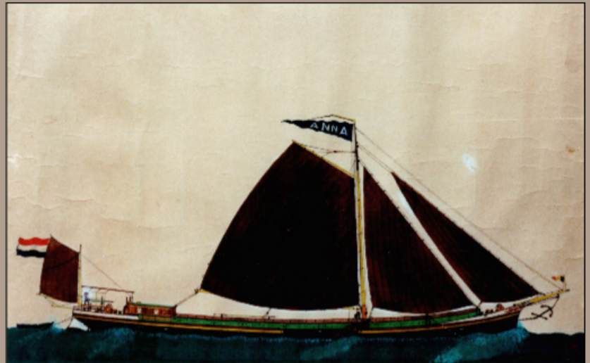
[ca 1903] De stalen klipper Anna, omgebouwd tot zeilschip (tekening ingekleurd met plakaatverf). Bouwjaar 1901, ca 336 ton, 39,6 x 6,59 meter, met liggend stuurrad
