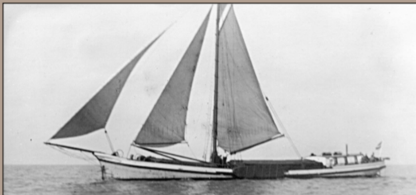
[ca 1920-1922] De Azolla varend op het IJsselmeer onder vol zeil, met gaffeltopzeil. Gebouwd in 1892 als sleepschip Hanna, ca 230 ton laadvermogen, 33,3 x 6,02 meter. Het schip had toen nog geen motor en geen stuurhut.
