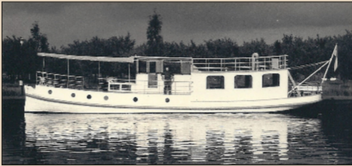
[ca 1958/1960] De Carpe Diem met schipper Henk dLvW midscheeps. Afmetingen 19,60 x 3,65 meter; Perkins dieselmotor van 100 pk, accommodatie acht 2-persoonshutten, salon met 16 zitplaatsen en kombuis.
