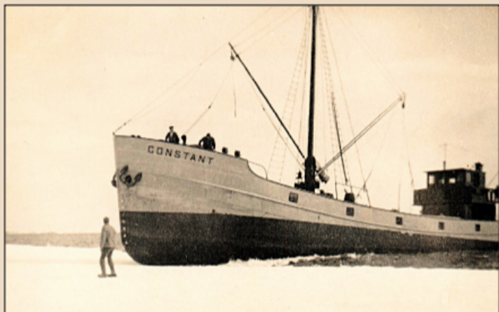
[1933 Grimboda] De Constant is vastgelopen op het ijs. Henk dacht met een vaartje het ijs wel te kunnen breken, maar het ijs bleek te dik en het schip schoof erop. Door de kop van het schip met een houtconstructie wat op te bokken, kon met de schroef het schip er weer afgetrokken worden.
