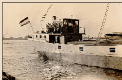
[16 juni 1932] Te waterlating van de nieuw gebouwde Constant op de werf in Deest Afmeting ca 36,7 x 6,3 meter, 199 ton, 2 cilinder motor van 110 pk
