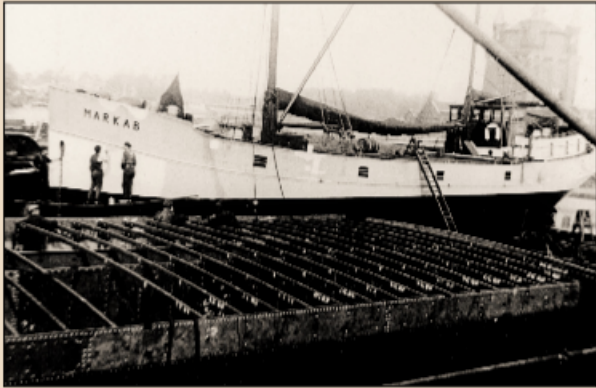
[ca 1929] De Markab op de werf in Dordrecht. Motorzeilschip met twee masten, 100 pk motor, laadvermogen ca 220 ton, ca 30 x 6 meter, bouwjaar 1926
